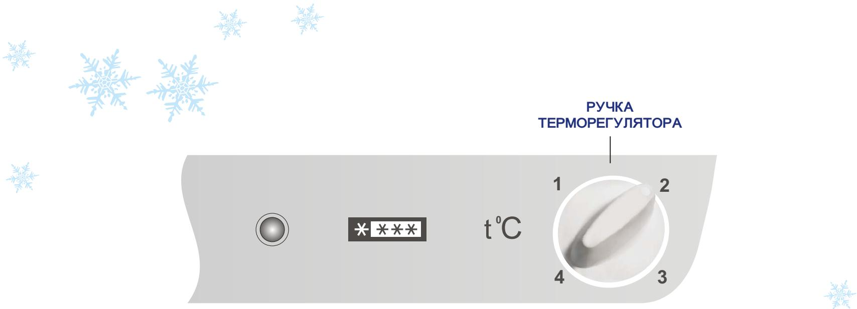
Органом управления холодильника является ручка терморегулятора, с помощью которой производится регулировка температуры. Ручка поворачивается по часовой стрелке и против нее и устанавливается меткой на выбранное деление.
